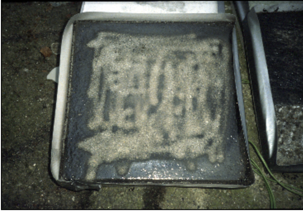
Abbildung 40: Entschichtung durch LN 2 und Vakuumsandstrahlen
